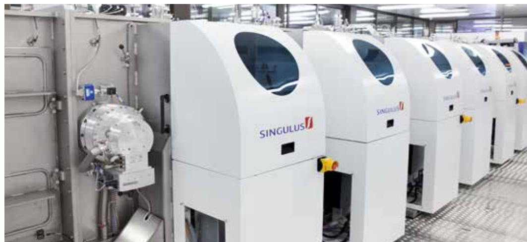
VISTARIS – Vakuum-Beschichtungsanlage für große Glasscheiben (Solarmodule, Displays, etc.)
