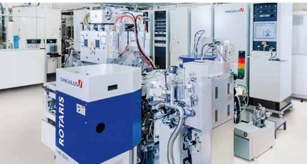
ROTARIS – Ultra-Hochvakuum- Beschichtungsanlage für Anwendungsforschung in der Halbleitertechnik
